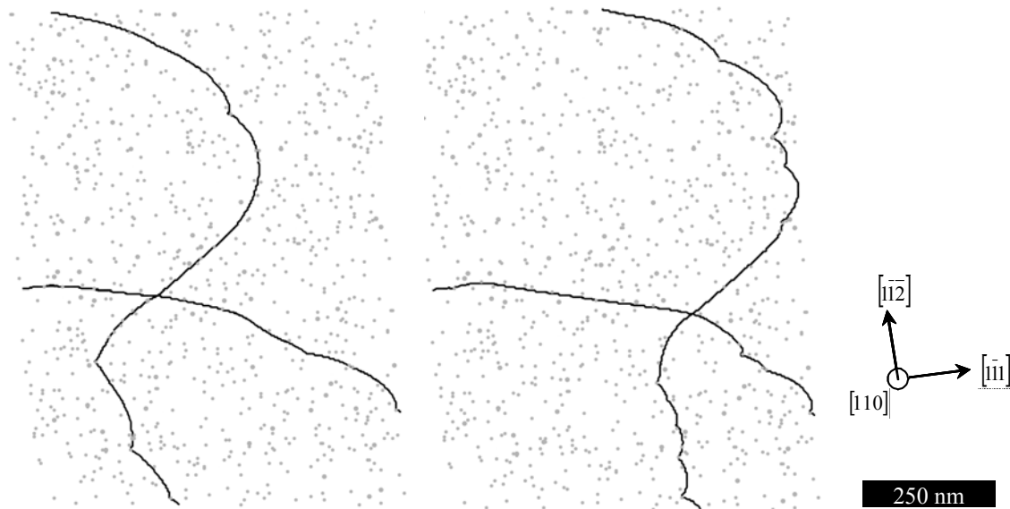
Figure VI.9. Séquence du mouvement de dislocations au travers une distribution de cavités. L'épaisseur de la lame mince est de 30 nm et a été obtenue sous chargement pour \gamma = 0,6\% . Le plan d'observation correspond au plan du système primaire. Il faut noter que, compte tenu de l'épaisseur de la lame, un bon nombre de cavités visibles ne coupent pas le plan de glissement des dislocations.
